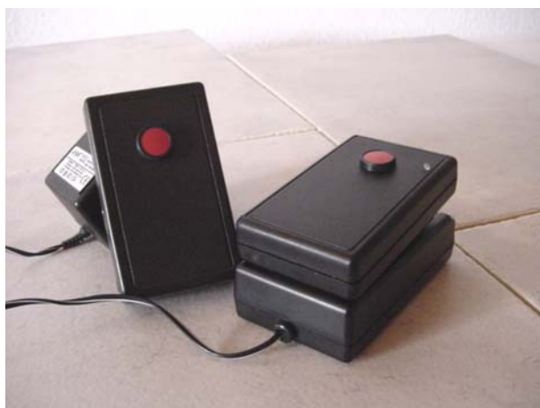
Notruf mobil komplett mit Sender, Empfänger und Ladestation mit Netzteil
